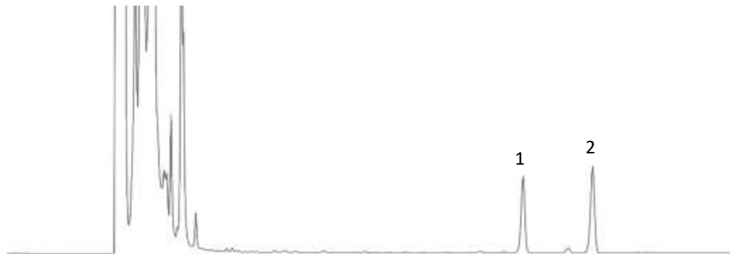
图2 氯氟醚菊酯电热蚊香液中七氟甲醚菊酯的典型气相色谱图
